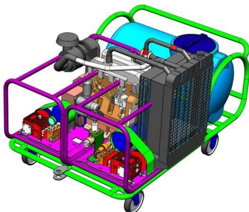
Модель насосной станции высокого давления с двумя модулями «Пульсар Э»
