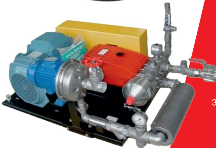
Плунжерные насосы высокого давления **Speck Triplex** специальной серии с литерой «D» - предназначены для **перекачивания горячей воды с максимальной температурой +105°C.**
